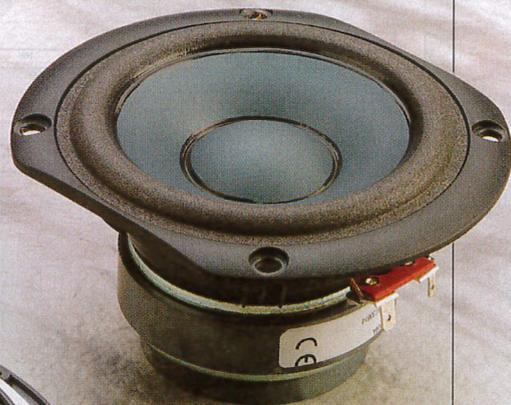
*Il midrange a cono da 10 cm lavora in una camera comunicante con l'esterno tramite i fori ricavati sulla modanatura esterna. Il suo magnete è schermato con l'aggiunta di un secondo anello in ferrite.*
